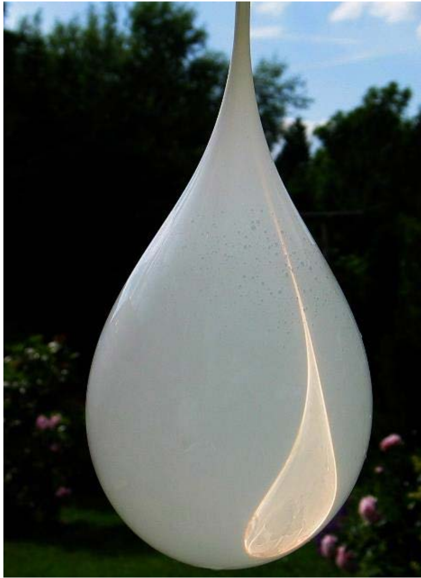
Abb. 04-07: Wasserballon als optische Linse. Druck und horizontaler Querschnitt durch den Ballon hängen in komplizierte Weise voneinander ab. (FB)
