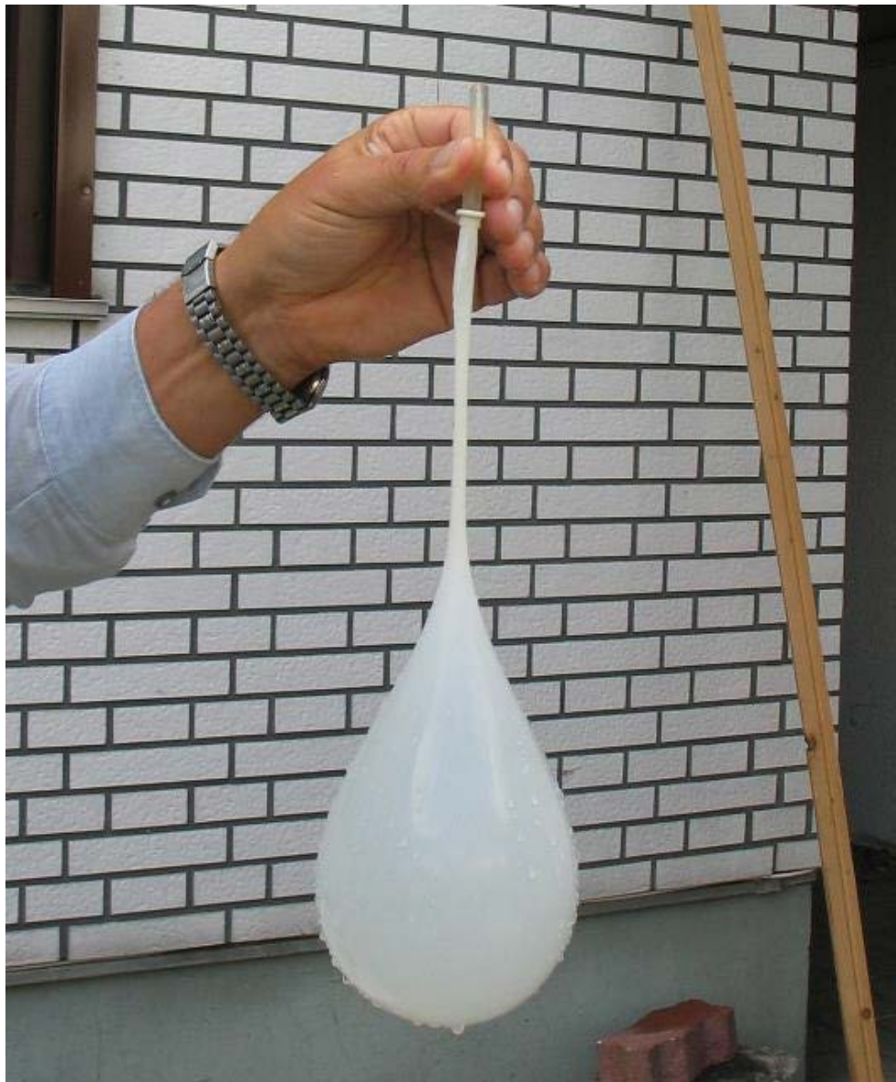
Abb. 04-03: Ballon mit Wasser gefüllt. Bei diesem langen Hals reicht der Druck (noch) nicht aus, um Wasser herauszupressen (FB)
