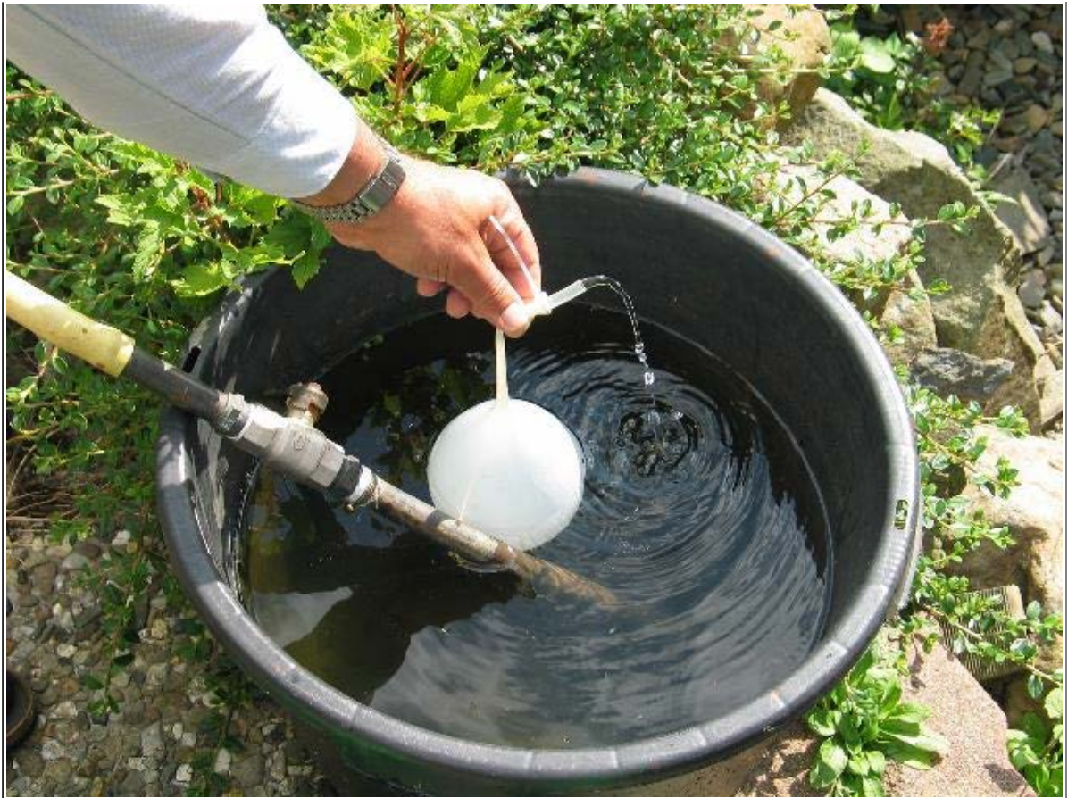
Abb. 04-06: Der Wasserballon taucht in das Wasser etwas ein und schwimmt teilweise. Wie von Zauberhand läßt sich der Wasserfluß ein- und ausschalten: Senkt man den Hals mit dem Auslaß, fließt Wasser heraus, hebt man ihn an, stoppt es. (FB)
