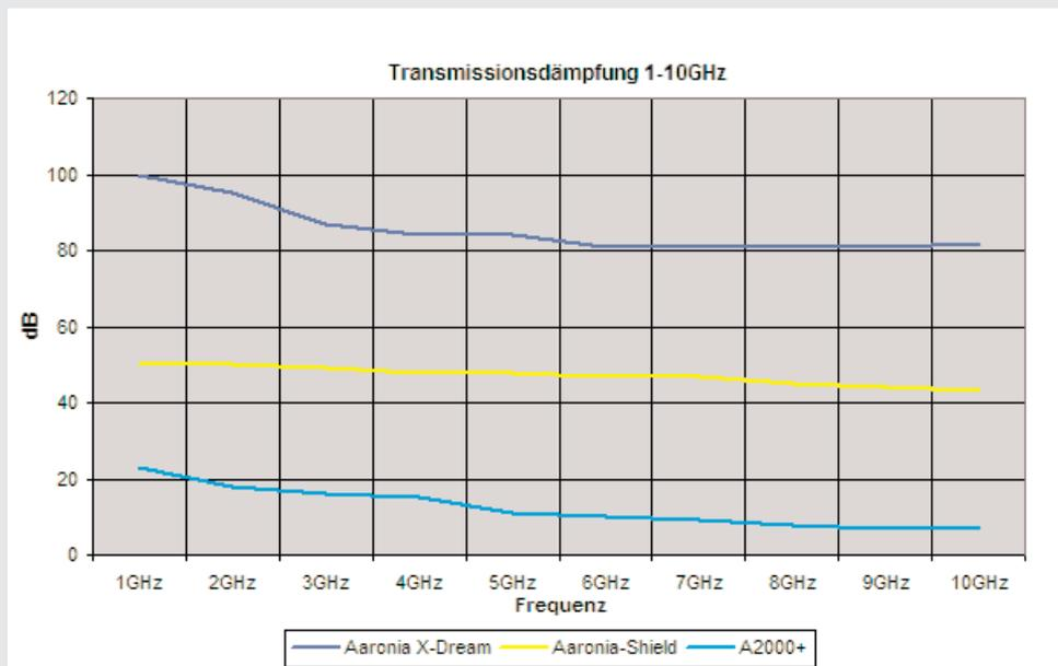
Messungen bestätigen die gute Abschirmleistung: Die Verringerung/Dämpfung von Hochfrequenzstrahlungen insbesondere im Bereich von GSM, UMTS und WLAN (900MHz-2,5GHz), beträgt 90% bis 99%.
