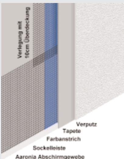
Um einen Raum gegen Hochfrequenzstrahlung abzuschirmen muss der gesamte Raum **lückenlos** mit dem Gewebe ausgekleidet werden. Soll hingegen eine niederfrequente E-Feld Strahlungsquelle (z.B. der Strom-Verteilerkasten oder Kabel in der Wand) abgeschirmt werden so muss nur ein kleiner Bereich um die strahlende Quelle herum mit dem Gewebe verkleidet werden.
