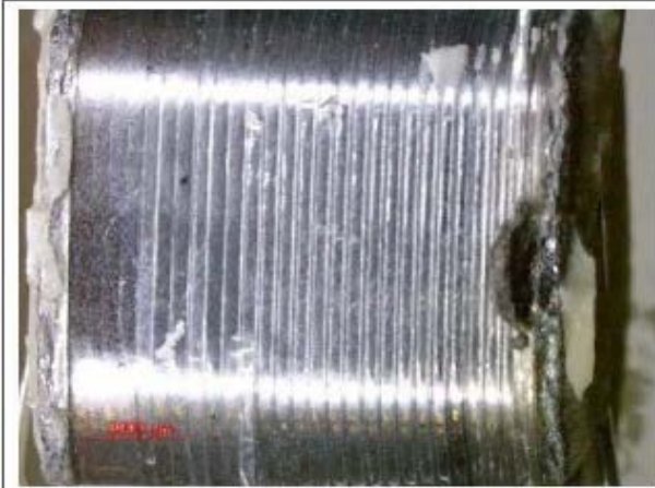
Freigelegter C, Durchschlag rechter Anschluss
